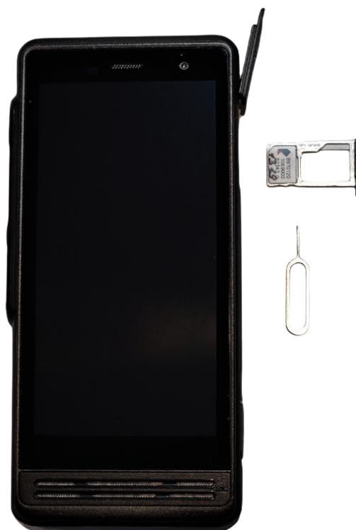
Рисунок 3 - Установка сим-карты с помощью специального инструмента
